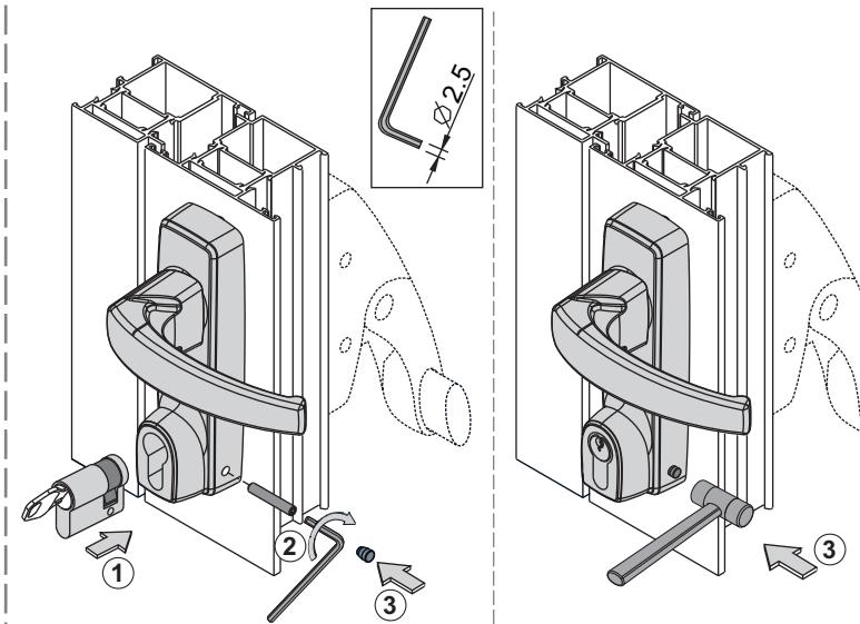
Sostituzione cilindro definitivo - Removal of final cylinder - Reemplacment du cylinder définitif - Reemplazo bombín definitivo - Demontieren des endgültigen Zylinders - Замена постоянного цилиндра - Demontaż wkładki docelowej
