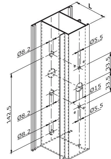
MONTAGGIO - FITTING - MONTAGE - MONTAJE -MONTAGE - становка - MONTAŻ
