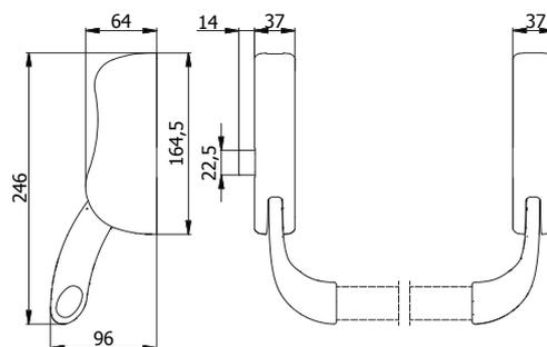
**ТЕХНИЧЕСКИЕ ХАРАКТЕРИСТИКИ:** крышки из крашеного алюминия - держатели из специального сплава - хромированная защелка - пружины из нержавеющей стали
