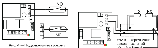
Рис. 4 — Подключение геркона Рис. 5 — Подключение оптоэлектронного SIGNAL12
